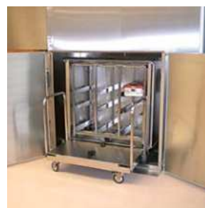
Durchreiheschrank Beladung mit Einschubgestell
