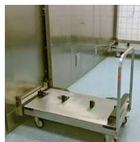
Andockung eines Übernahmewagens an den Sterilisator
