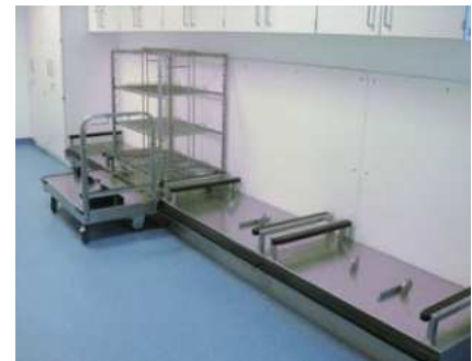
Sterilgutlager mit Elementen des Hammerlit Shuttle-Systems
