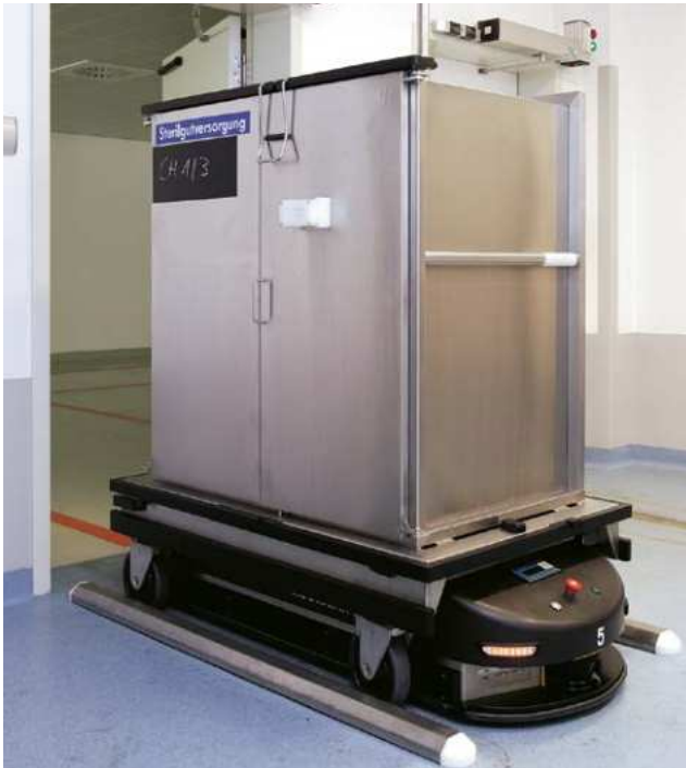
FTS-Transportwagen wird vollautomatisch abgeholt
