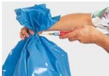
Drahtschlingen **MS 03** dienen zum Verschließen der Abfallsäcke und werden mit dem Drillapparat verschlossen.
