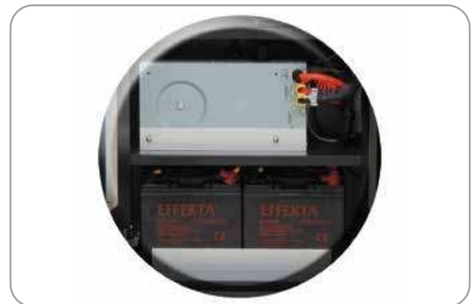
PSS Power Supply System inkl. Akku für ca. 14 Std. Laufzeit
