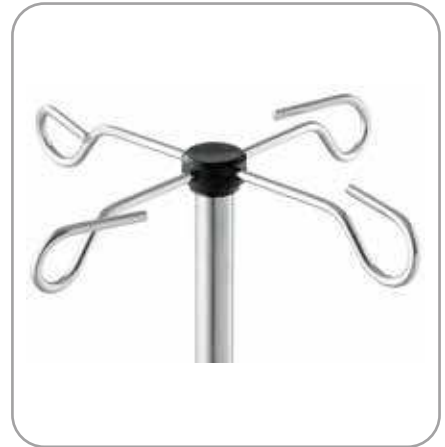
IFS-FKE Flaschenkreuz zum Einpressen Belastbarkeit 2 kg pro Haken
