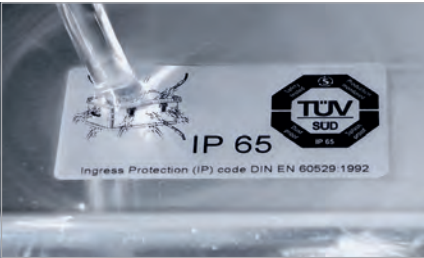
Strahlwasserschutz nach Norm IP 65
