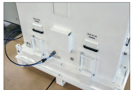
Wasserdampfdichter Behälter bei Dichtheitsprüfung durch Überdruck
