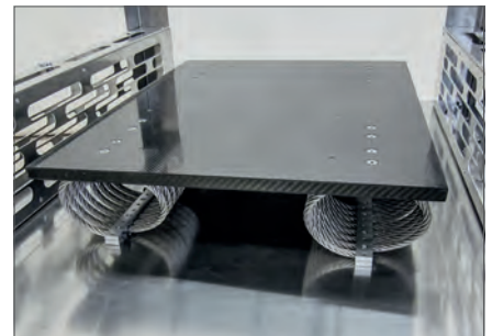
Aufnahmetisch, schwingend gelagert mit Gummipuffer oder Drahtseildämpfer
