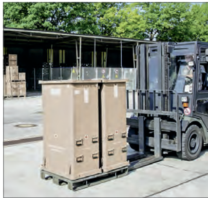
Palettenunterbau vereinfacht das Handling
